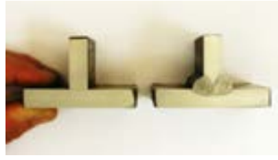
Assemblage en angle de plaques acier C-Mn épaisseur 10 mm avec une variante MAG à forte pénétration : pas de chanfrein à usiner, temps de soudage divisé par deux par rapport au procédé MAG conventionnel
